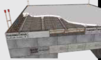
SOLUTION N°4: Entrevous béton + Thermo'Rive
